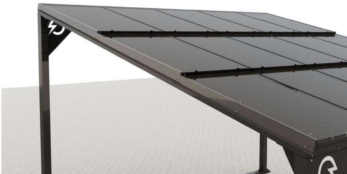
○ **Schritt 18** - Montage der oberen Eindeckrahmen
