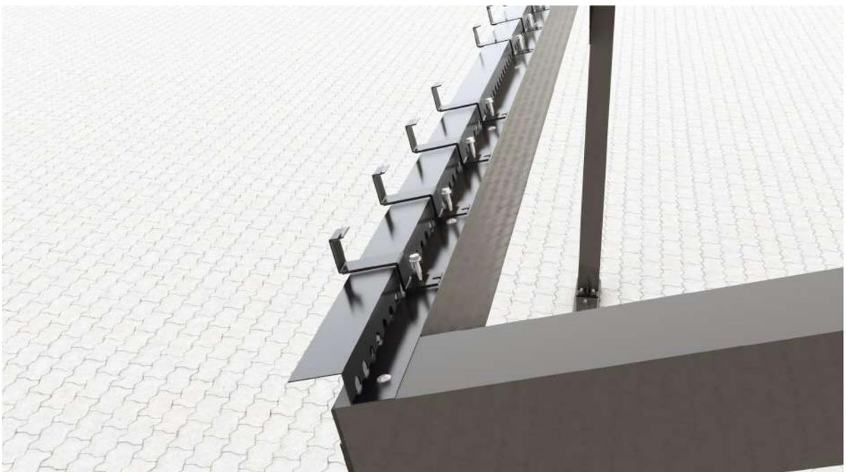
● **Schritt 14** - Montieren Sie die Klammern der ersten Reihe, die Lüftungsleiste und die PV-Paneele der ersten Reihe
