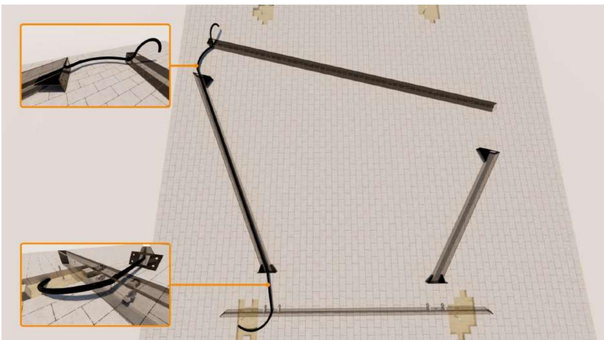
○ **Schritt 4** - Verbindungsbolzen in die Grundschiene einsetzen
